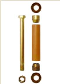
Der wärmebehandelte Haupttrahmen zusammen mit den Schrauben, Distanzrohr, zwei Kegeln und gehärteten Buchsen sorgen für eine einzigartige, verschleißfreie Verbindung zwischen Grindel und Haupttrahmen.
