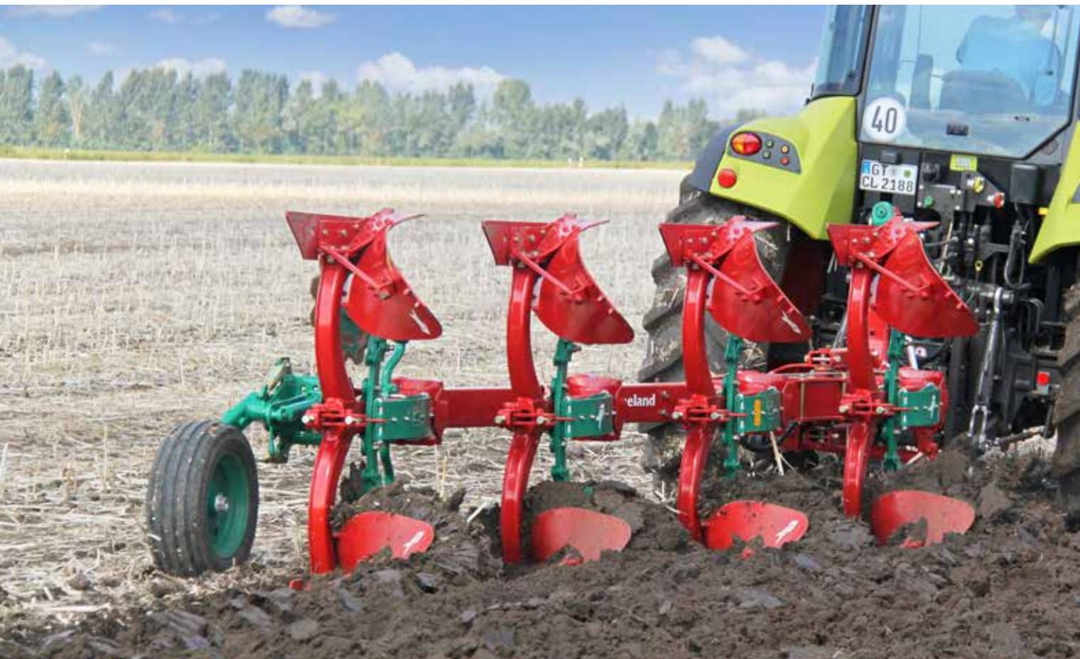
Kverneland 150 S – mit Kverneland Steinsicherung (S = Stein)
