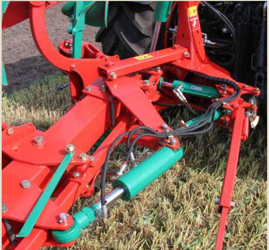
Parallelogrammführung mit Memoryzylinder und hydraulischer Einstellung der Vorderfurchen.
