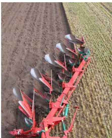
**Die Modelle 150 B/S Variomat® basieren auf dem gleichen Prinzip wie die Modelle 150 B/S. Grundlegender Unterschied ist hier die Variomat® Schnittbreitenverstellung. Dieses System erlaubt die einfache Einstellung der Arbeitsbreite während des Pflügens.**
