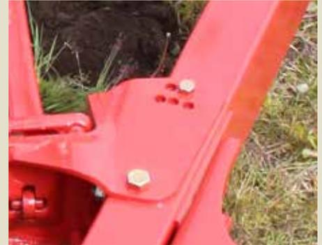
Manuelle Schnittbreitenverstellung in 5 cm Schritten
