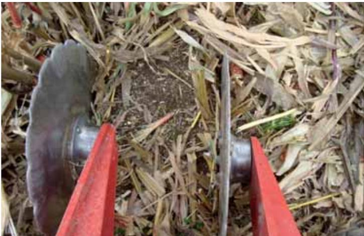
Das vordere Schneidscheibensegment kann jederzeit von der Kabine aus eingestellt werden. Der Druck der Scheiben wird über die Position des Zylinders definiert. Die Arbeitstiefe liegt bei ca. 5 cm, so dass Ernterückstände und Wurzeln durchschnitten werden. Jede Scheibe wird unabhängig von vier Gummidämpfern geschützt. Alle Lager sind wartungsfrei!
