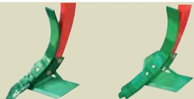
**NEU! Quantum Schar** - die Kombination mit einer 80 mm Knock-on® Wechselfspitze oder einem 80 mm Tiger Point ist vor allem für schwere Böden geeignet. Das Zusammenwirken von Spitze und 345 mm Flügel-schar sorgt für ein sehr gutes Eindringen in den Boden, eine ganzflächige Stoppelbearbeitung und eine optimale Vermischung von Stroh und Boden bei einer Arbeitstiefe von 5 bis 12 cm.
