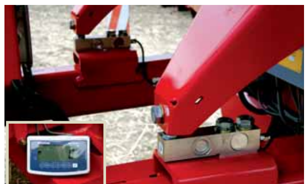
Über die optional verfügbare Wiegeeinrichtung kontrollieren Sie schnell und einfach die Dünger- oder Saatgutmengen im Tank.
