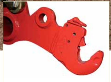
FlexCart mit Kat II Fanghaken (Walterscheid)
