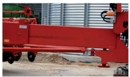
Die Basis der Optima TFmaxi bildet ein stabiler, teleskopierbarer 250 x 450 mm Rahmen. Die komplette Energiekette für Elektronik und Hydraulik ist sicher innerhalb des Rahmens verlegt.
