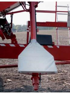
Mit der optional erhältlichen Schnecke ist die Tankbefüllung auch von unten möglich (Füllhöhe 750 mm). Die Schnecke klappt automatisch aus, wenn die Maschine in Arbeitsposition gebracht wird.
