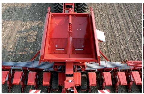
Der große Saattank mit einer Kapazität von bis zu 4.000 Litern ist für Wartung oder Überwachung dank Leiter und sicherer Plattform bequem zugänglich. Der klappbare Tankdeckel kann vollständig geöffnet werden, so dass die Befüllung mit Frontlader oder Big Bag erfolgen kann.
