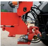
Extreme Wendigkeit wird nicht zuletzt dadurch erreicht, dass der hydraulische Antrieb über der Gelenkwelle an die Tragachse montiert ist. Der Einschlagwinkel von 80° gewährt eine optimale Anschlussfahrt. Hohe Stabilität verspricht auch die
