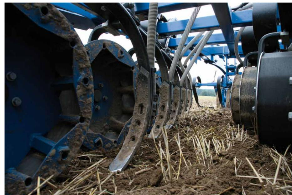
Eine vorlaufende Stützrolle tastet die Kontur des Bodens ab. Der nachfolgende Säzinken folgt der Stützrolle und hält die eingestellte Ablagetiefe exakt ein. Änderungen der Ablagetiefe können hydraulisch vom Schlepper aus eingestellt werden. Alle Säelemente sind über Hydraulikleitungen miteinander verbunden. Bei Hindernissen, wie zum Beispiel großen Steinen, können die Zinken ausweichen, ohne dabei beschädigt zu werden.
