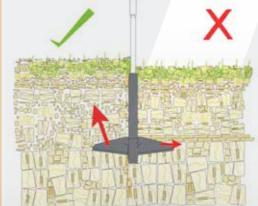
hebt und lockert die obere Bodenlage, reduziert die Schüttdichte und Verdichtung und sorgt dabei für eine minimale Beeinträchtigung der Oberfläche. Der allgemeine Erdstrom sollte NACH OBEN verlaufen (wie links von der Mitte dargestellt) und nicht nach außen bzw. nach unten (Wischeffekt, siehe rechts von der Mitte). Zinken, die das Erdreich SEITWÄRTS bewegen, beseitigen nicht die Schadverdichtung, sondern verschlimmern sie sogar im ungünstigsten Fall.
