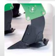
PRO-LIFT-LOCKERUNGS-ZINKEN - Die Pro-Lift-Kombination aus Anker und Zinkenspitze fördert eine höchst effektive Bodenbearbeitung bei längerer Nutzungsdauer. Die Zinken greifen bei Modellen mit hydraulischem Rücksteller bis zu einer Tiefe von 350 mm und bei der Baureihe 500 und dem klappbaren Flatliner bis zu 500 mm tief ein.
