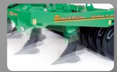
HYDRAULISCHES RÜCKSTELLSYSTEM – Flatliner lic Reset – Die Zinken werden auch mit seh n Röden und unterschiedlichen Ackerbedir gungen fertig. Jede Zinke wird hydraulisch gesteuer was ein schnelles Auslösen und Rückstellen währender Arbeit ermöglicht. Der Druck für die automatisch Rückstellung ist einstellbar. Die Hydraulik ist vollständig mit Druck beaufschlagt, um Wartungs- und
