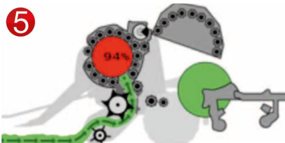
5 Die Heckklappe wird geöffnet und der Ballen wird direkt auf den Wickeltisch übergeben.
