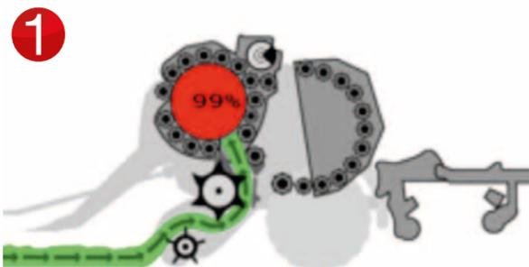
1 Zu Beginn des Pressvorganges wird die Vorkammer gefüllt bis der eingestellte Pressdruck erreicht ist.
