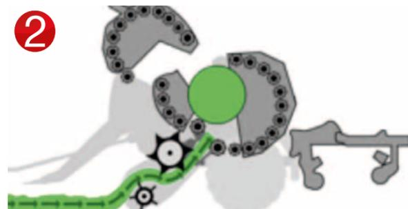
2 Der Erntegutfluss wird in die Hauptpresskammer umgeleitet.
