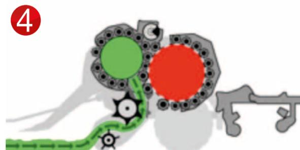
4 Sobald der Pressvorgang in der Hauptpresskammer abgeschlossen ist, wird der Erntegutfluss in die Vorkammer geleitet und die Netzbindung gestartet.
