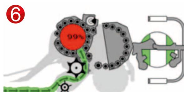
6 Nach der Ballenaufnahme wird der Wickelrahmen angehoben und der vertikale Doppelsattelitenwickler startet mit dem Wickelvorgang.
