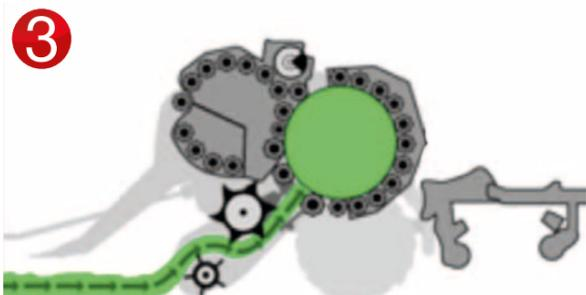
3 Der Pressvorgang wird in der Hauptpresskammer bis zum eingestellten Pressdruck fortgeführt.
