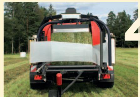
Der Wickeltisch fährt unter die Heckklappe der Presse, wodurch der Ballen direkt auf den Tisch abgelegt wird.
