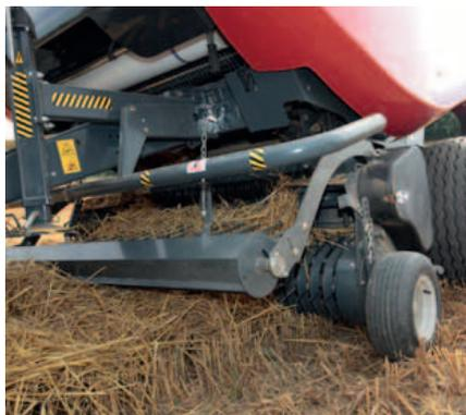
Der Rollenniederhalter sorgt für eine Vorverdichtung des Erntegutes und unterstützt den Materialfluss. Besonders bei ungleichmäßigen Schwaden wird der Materialfluss verbessert und die Verstopfungsgefahr minimiert.
