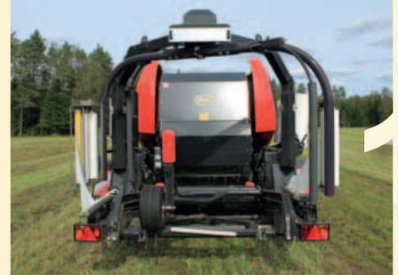
Sobald das Netz um den Ballen gewickelt wird fährt der Wickeltisch für die Ballenübergabe unter die Heckklappe der Presse.
