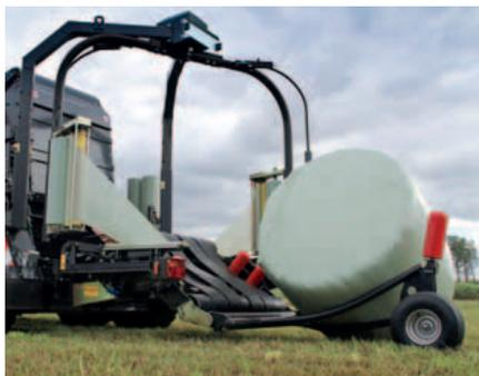
Ein Ballendreher ist als Option verfügbar. Während des Transports wird der Ballendreher automatisch in einer sicheren Position im Wickler verstaut.
