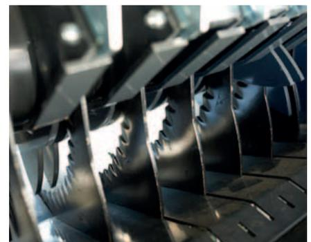
Mit einer Schnittlänge von 70 mm ist das SuperCut-14 Schneidwerk die ideale Lösung für feste Ballen und erstklassige Silagequalität.
