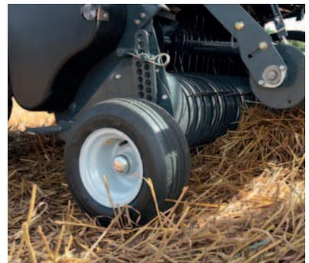
Die leicht in der Höhe verstellbaren Pickup-Tasträder sind luftbereift. Das einzigartige Pickup-Design ermöglicht eine kompakte Position der Tasträder und vermeidet eine große Transportbreite.
