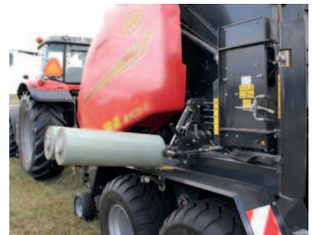
Die Ersatzrollen werden hydraulisch herausgeschwenkt.
