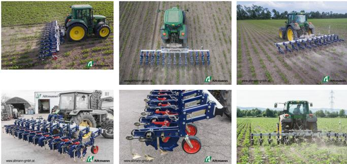
**Type:** Hackgerät 6m mit Kamerasteuerung
