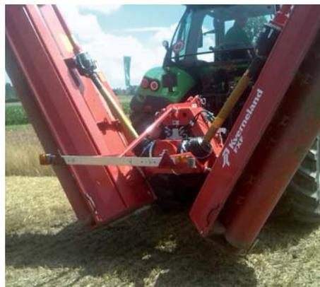
Der hydraulisch klappbare Rahmen stammt aus der Kverneland Kreiselregenfamilie; robust und verlässlich auch unter harten Bedingungen. Die hydraulische Sperre ist Standard.
