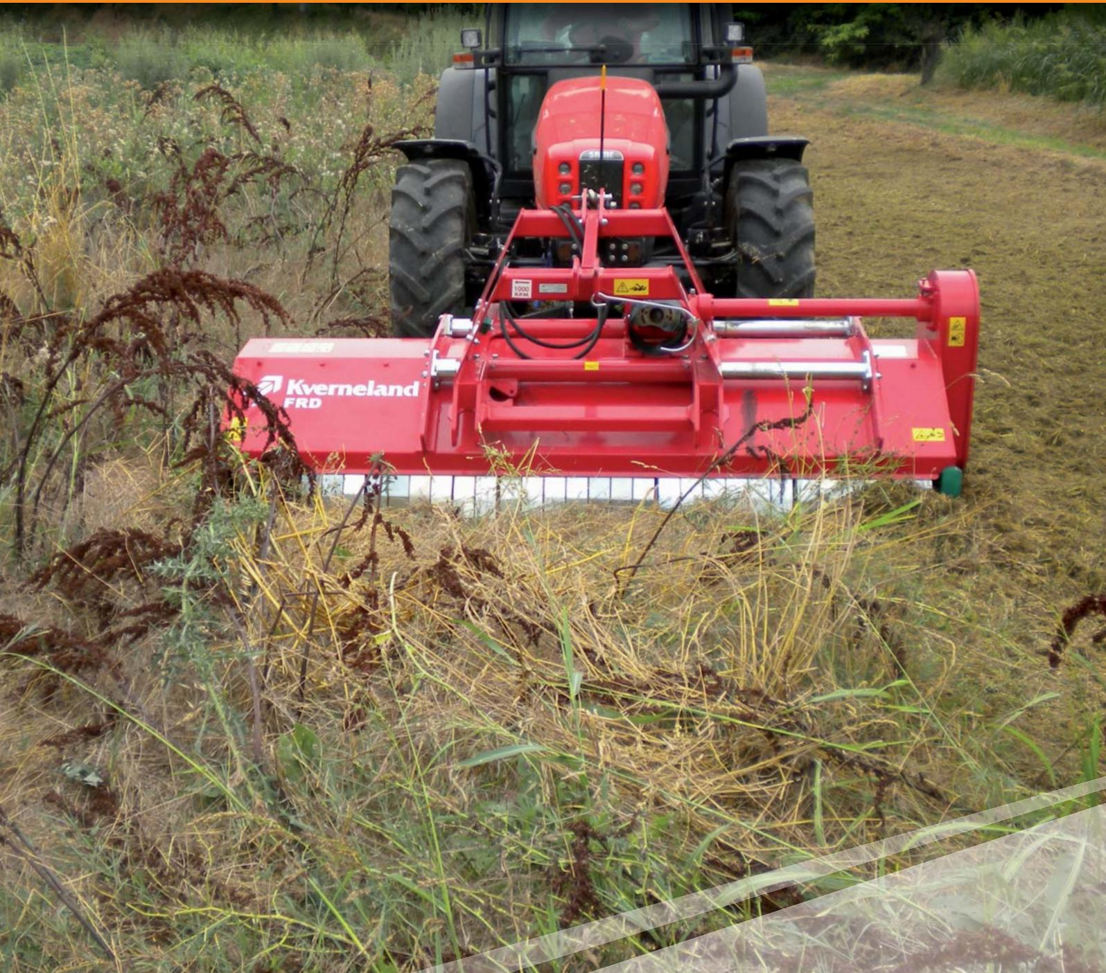
Der doppelte Anbaubock ermöglicht die Nutzung des FRD sowohl im Front- als auch im Heckanbau. Die serienmäßige hydraulische Verschiebung von bis zu 52 cm macht den FRD zu einem effizient und universell einsetzbaren Gerät.
