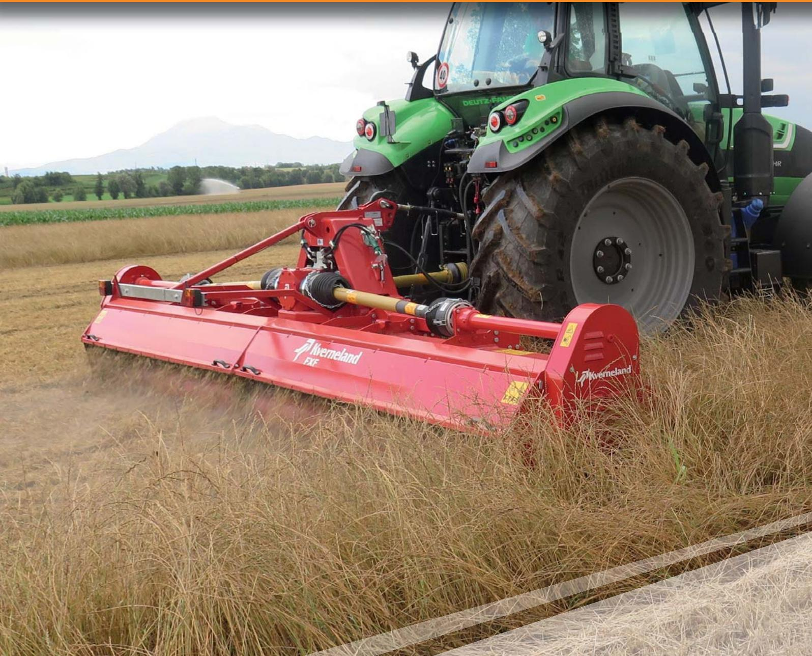
Der klappbare FXF ist in 5,60 m und 6,40 m Arbeitsbreite erhältlich und wird von Schleppern bis 260 PS gezogen. Groß im Feld, schmal unterwegs: Der FXF wird auf 2,50 m Transportbreite geklappt.
