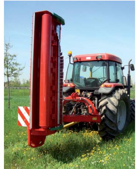
Robust und geschützt. Hauptrahmen und Parallelogramm werden entsprechend der FEM-Kalkulation und dem Streßtest auf dem Schüttelprüfstand in Klepp (Pflugproduktion Norwegen) ausgiebig getestet, um ein zuverlässiges und sicheres Arbeiten zu gewährleisten. Getriebe und Kraftübertragung sind gegen Überlastung geschützt.
