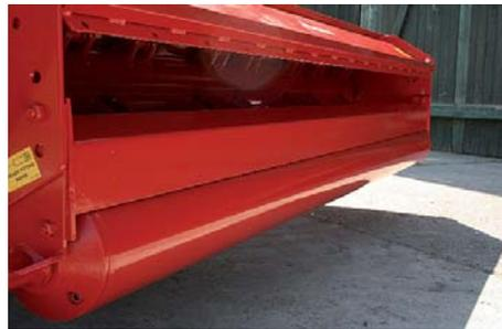
Die nachlaufende Stützwalze hat standardmäßig einen Durchmesser von 160 mm. Der einstellbare Abstreifer sichert ein perfektes Ergebnis.
