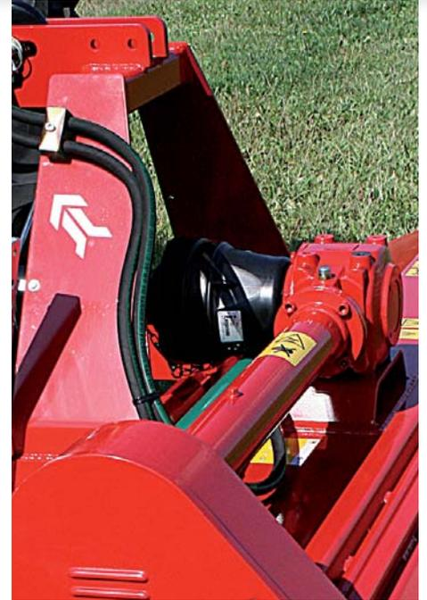
Für Traktoren von bis zu 80 PS. Zapfwellenschwindigkeit 540 oder 1000 U/min durch Wechsel der Riemenscheiben. Sicherung durch integrierten Freilauf.
