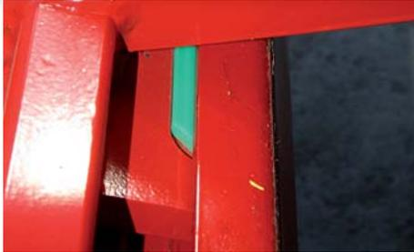
Spezielle Führungsbuchsen aus Nylon sichern einen ruhigen Lauf ohne zusätzliche Schmierung oder Wartung.
