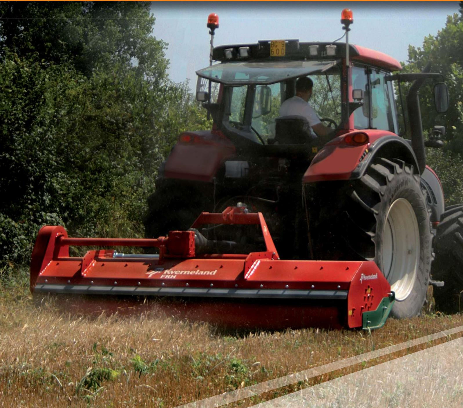
Der Kverneland FRH ist ein vielseitiger Mulcher für Gras, Weideland, unbewirtschaftete Flächen und Stoppelland. Die hydraulische Seitenverschiebung des FRH ermöglicht das Mulchen von Feldrändern, Obstplantagen und Straßenrändern. Hammerschlegel und universelle Y-Schlegel mit kurzen Lüftungsmessern sorgen für ein perfektes Mulchergebnis in allen Bedingungen.
