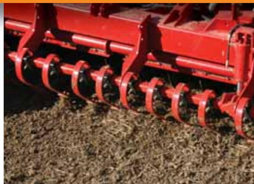
Als einzige Maschine im Bereich der gezogenen Drillmaschinentechnik bietet Kverneland Accord für die DG optional ein zweireihiges Zinkenfeld oder Clod Board zur Saatbetteinebnung an. Die Paddel/Zinken sind einzeln aufgehängt und überlastgesichert. Je nach Bodenbeschaffenheit und zur Verfügung stehender Zug-
