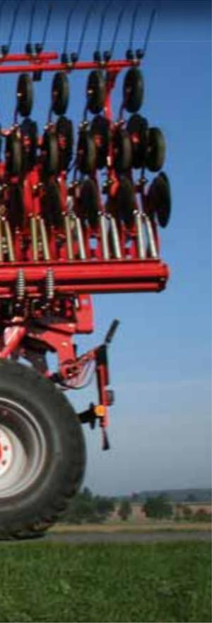
Durch das kompakte Design der DG bedarf es keiner Sondergenehmigung für den Straßentransport. Die Abmessungen liegen mit einer Breite von 3 Metern und einer Höhe von 4 Metern (Striegel) innerhalb der Norm der Straßenverkehrs-Zulassungs-Ordnung. Das Gefährt ist somit auch brücken- und tunneltauglich.
