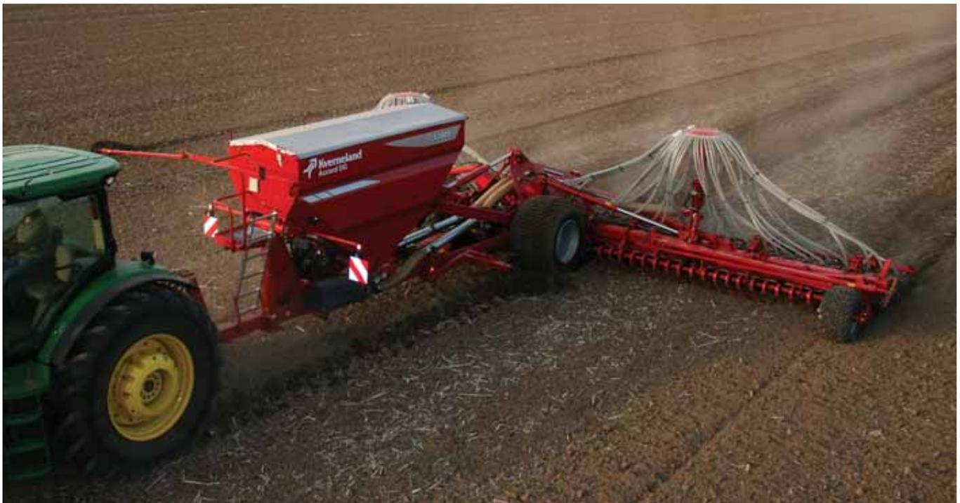
Nach dem Befahren des Feldes in Transportstellung wird mit nur einem Handgriff die Maschine in weniger als 2 Minuten in Arbeitsstellung gebracht. Nach Umlegen des Hebels am Ventil für die Transportsicherung werden die Scharschienenflügel vom Schlepper aus automatisch ausgeklappt. Das manuelle Umschalten ist dabei weniger ein Aufwand als mehr eine zusätzliche Sicherheit im Umgang mit der Maschine.
