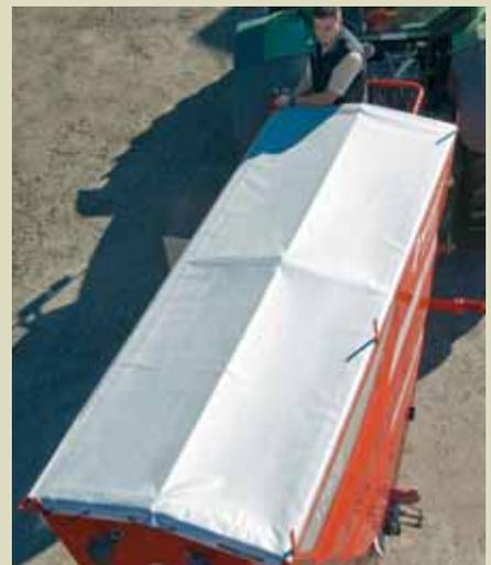
Die Befüllung des Tanks kann problemlos mit Big-Bags durch Frontlader- oder Teleskoplader-Einsatz erfolgen. Auch die Befüllung mit Hilfe eines Überladewagens ist durch die durchdachte Anordnung problemlos möglich. Mit 6.000 Litern Fassungsvermögen ist der Saatguttank der Größte seiner Klasse und erfüllt damit schon die Voraussetzung für höchste Schlagkraft!
