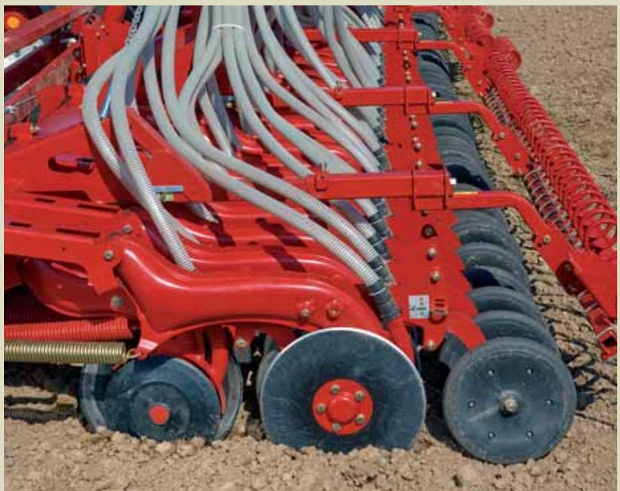
Eine Sätiefeneinstellung an jedem einzelnen Schar ist bei der DG nicht erforderlich. Diese Maschine steht für einfache Handhabung und somit kann auch die Sätiefe von 0 bis 9 cm stufenlos für alle Schare gleichzeitig an einem zentralen Punkt eingestellt werden. Einfacher geht's nicht! Das Risiko für Fehleinstellungen ist damit um ein Vielfaches geringer als bei vergleichbaren Maschinen im Markt.
