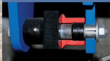
An allen wichtigen Dreh- und Befestigungsstellen wird der Bolzen "LockPin" eingesetzt. Das Prinzip: Eine Achse ersetzt herkömmliche Bolzen. Auf die konusförmigen Enden der Achse werden hochwertige Hülsen gesteckt. Mittels einer Schraube werden die Hülsen und Achsen in den Drehpunkten verspannt und so fixiert.
