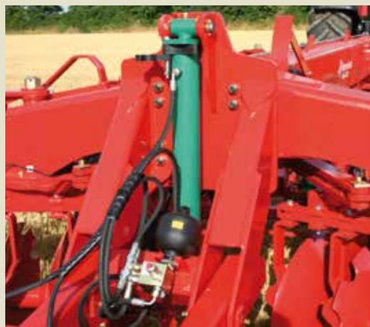
Die Tiefeneinstellung der Walze erfolgt mittels Distanzscheiben, die am Hydraulikzylinder eingeschwenkt werden können. Ein Druckspeicher sorgt dafür, dass die Walze eine konstante Tiefenführung hat, aber auch bei größeren Hindernissen (Steine) ausweichen kann, um so mögliche Beschädigungen zu vermeiden. Ein Sicherheitsventil schützt das Scheibensegment auch in eingeklappter Position: sollte versehentlich das Scheibensegment vor der Walze betätigt werden, öffnet sich das Ventil nicht.
